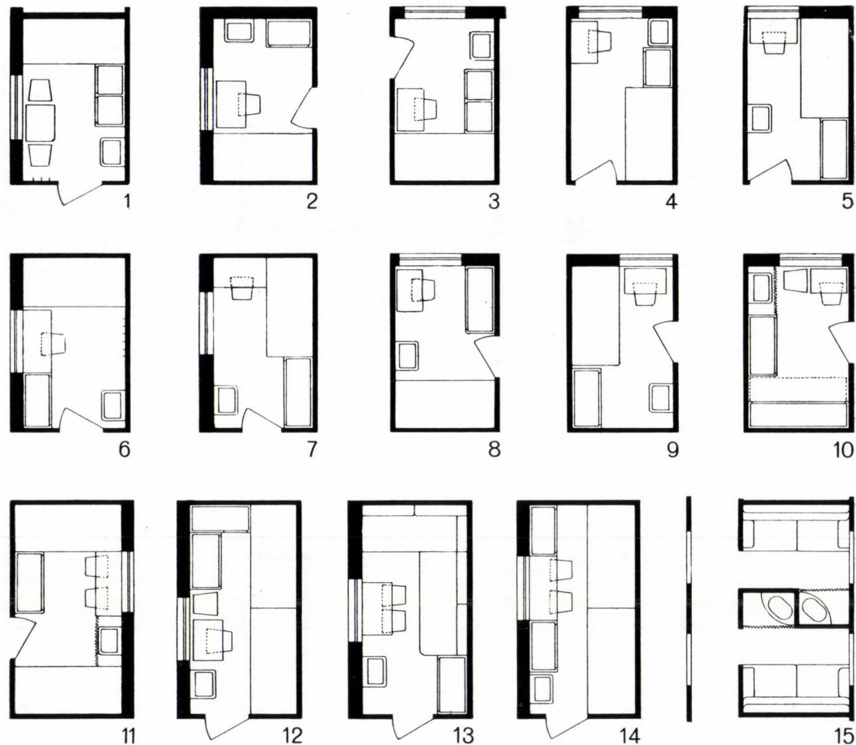
1—10. Személyzeti szoba 6 m 2 alapterülettel, ugyanazokkal a berendezési tárgyakkal és alaprajzi formával (2×3 m.), különféle ajtó és ablak állítás szerint, más és más bútorcsoportosítással. — 10. Kis diákszoba szekrény-ágygal, beépített mosdóval (függöny). — 11—14. Kétszemélyes személyzeti szobák a 13. sz. két pamlag-ágygal, 15 m. német hálókocsi, alaprajz (8 m 2 ), 4 ágygal.
